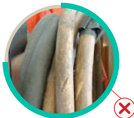
氣焊設備軟喉表面有破損
