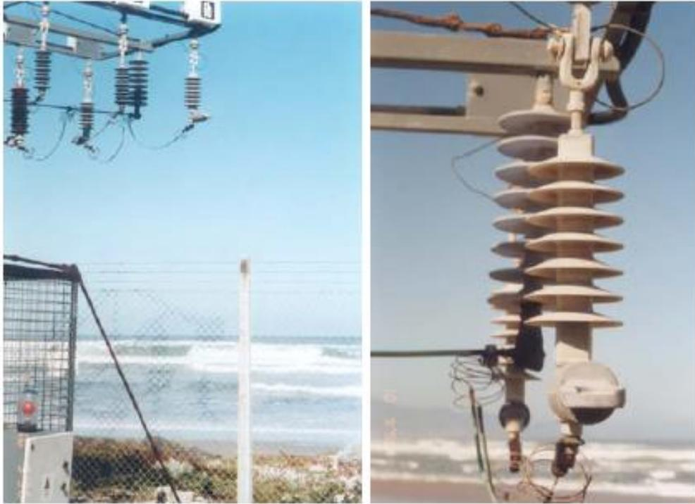
圖 3.15 中壓避雷器安裝在南非岸邊試驗[3]
