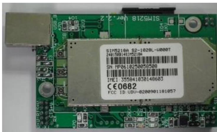
圖 6.17 GSM/GPRS 型資料蒐集與控制模組圖背
