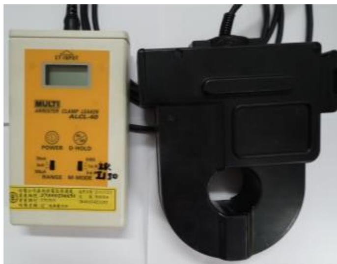
圖 6.55 ALCL-40 洩漏電流計
