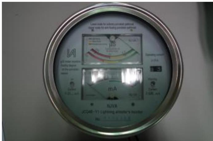
圖 6.19 JCQ4 型避雷器用監測器
