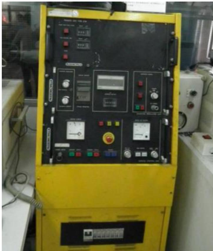
圖 6.47 衝擊電流試驗設備
