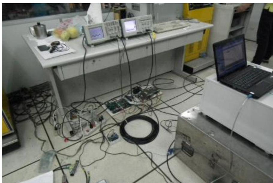
圖 6.48 測試板、示波器與監控電腦設備現場圖
