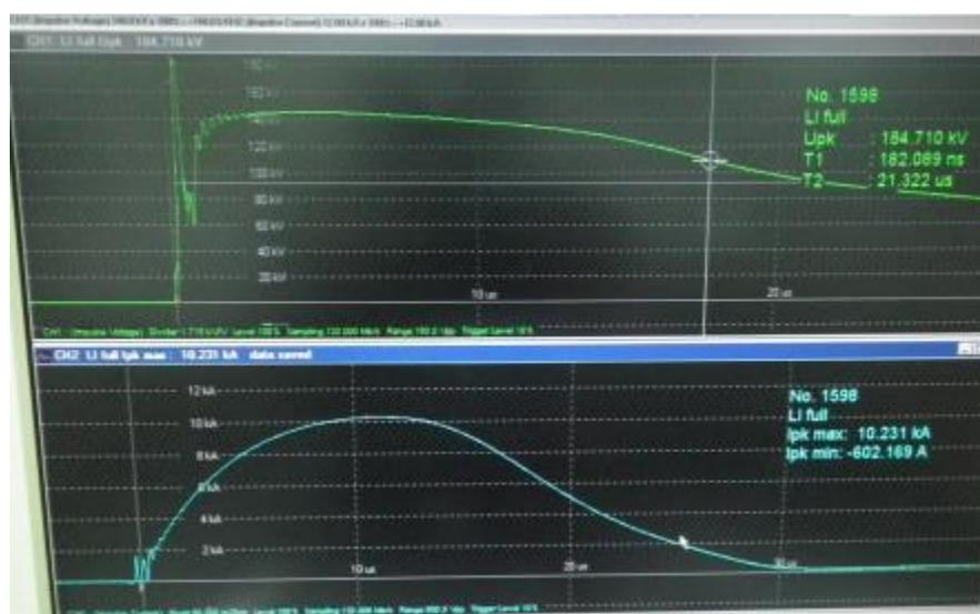
圖 6.52 衝擊電流儀器之畫面
