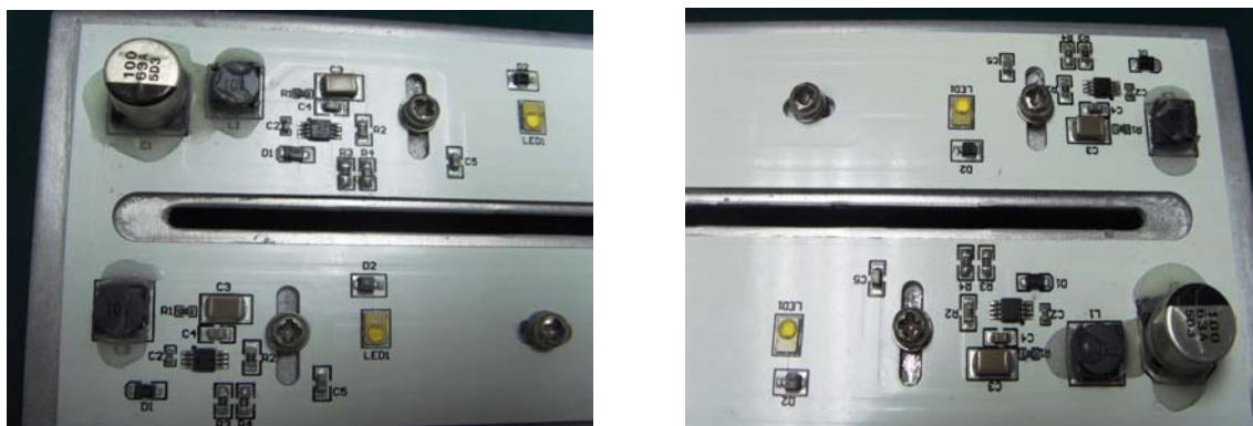
图 6-24 DC/DC 恒流电路集成与灯具铝基板上（灯具左端、右端）
