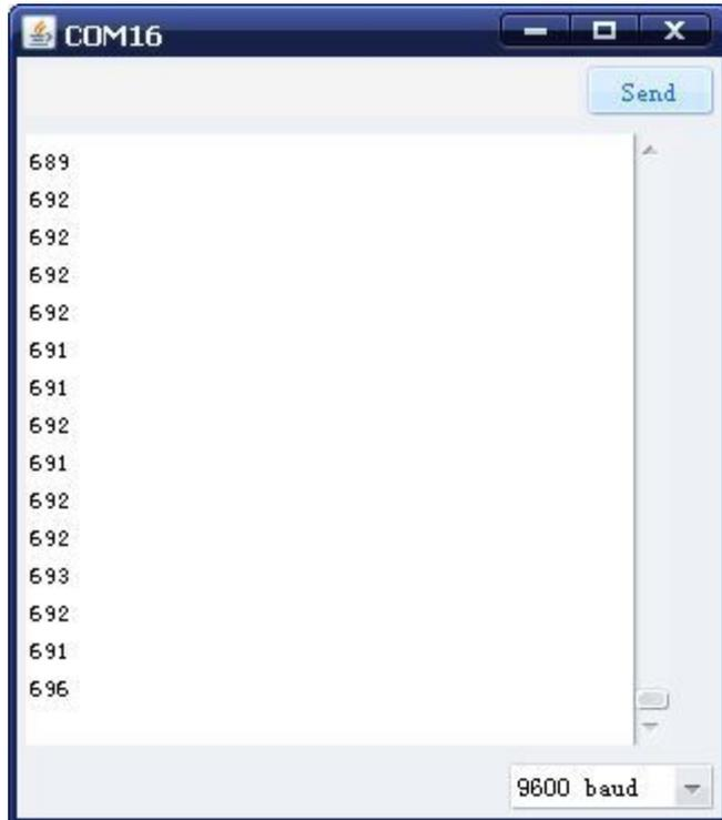
本实验到这里就完成了，当您旋转电位计旋钮的时候就可以看到屏幕上数值的变化了，读取模拟值这个方法将一直陪伴我们，模拟值读取是我们很常用的功能，因为很多传感器都是模拟值输出，我们读出模拟值后再进行相应的算法处理，就可以应用到我们需要实现的功能里了。
