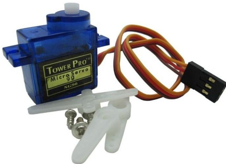
舵机有很多规格，但所有的舵机都有外接三根线，分别用棕、红、橙三种颜色进行区分，由于舵机品牌不同，颜色也会有所差异，棕色为接地线，红色为电源正极线，橙色为信号线。
