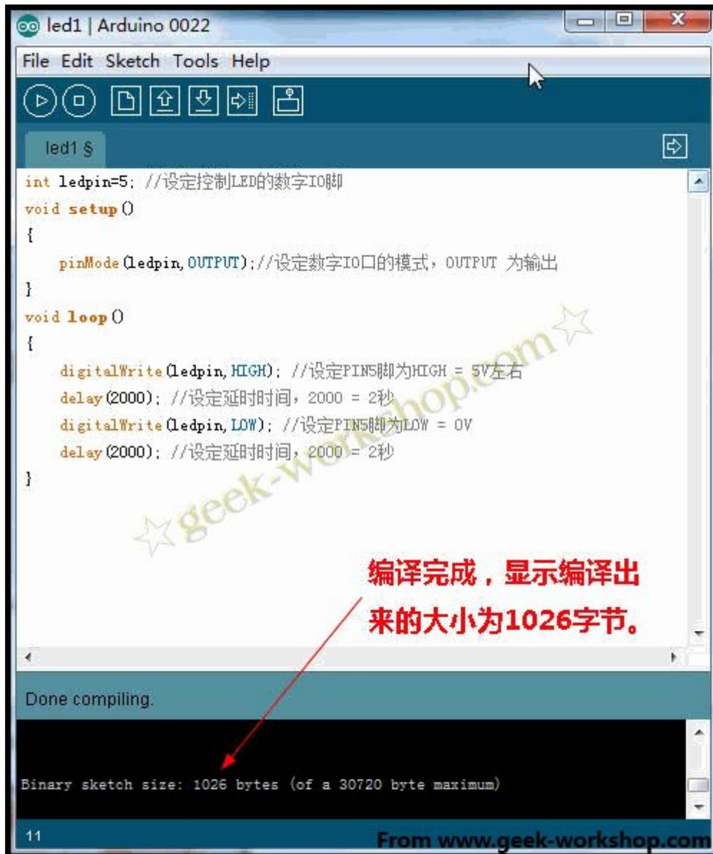
然后把编译好的程序下载到 arduino 控制板上，点击下载按钮。
