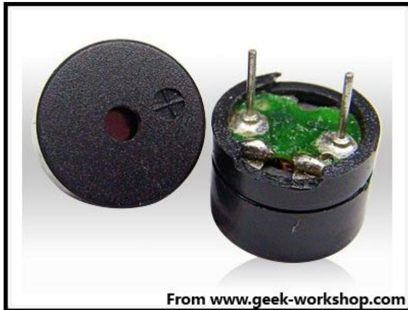
从外观上看，两种蜂鸣器好像一样，如果将蜂鸣器引脚朝上时，可以看到，有绿色电路板的是一种无源蜂鸣器，没有电路板而使用黑胶密封的是一种有源蜂鸣器。从外观上并不能绝对的区分出有源与无源，最可靠的办法除了查看产品的参数手册以外，还有就是使用万用表测试蜂鸣器电阻，只有  $8\Omega$  或者  $16\Omega$  的是无源蜂鸣器，电阻在几百欧以上的是有源蜂鸣器。
